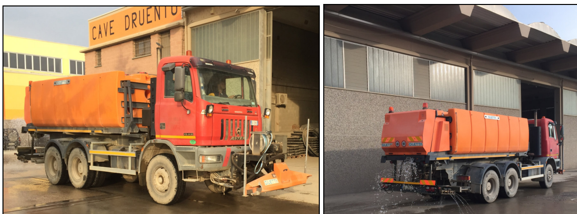
Mezzo utilizzato per la bagnatura dei piazzali e delle piste
